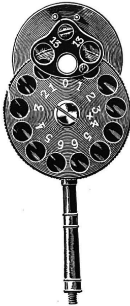
Fig. 25. Augenspiegel mit drehbarer RECOSSscher Scheibe (Rückseite), deren Gläser sich hinter die Perforationsöffnung des Spiegels legen lassen.
