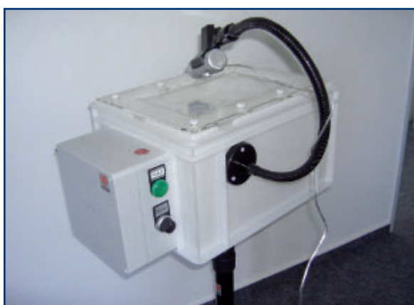
Abb. 8 A,B,C: Elektrische Teile des Pelvitainers und Vorrichtung für die Kamera zum Anschluß am Laptop.
